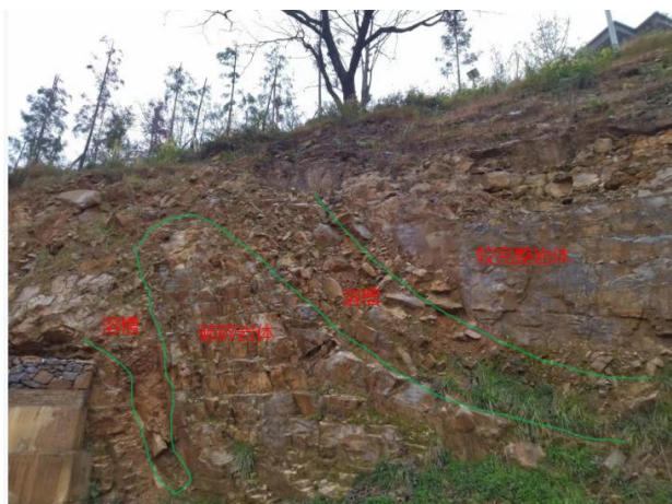
图1 岩溶及岩体破碎情况调查图
