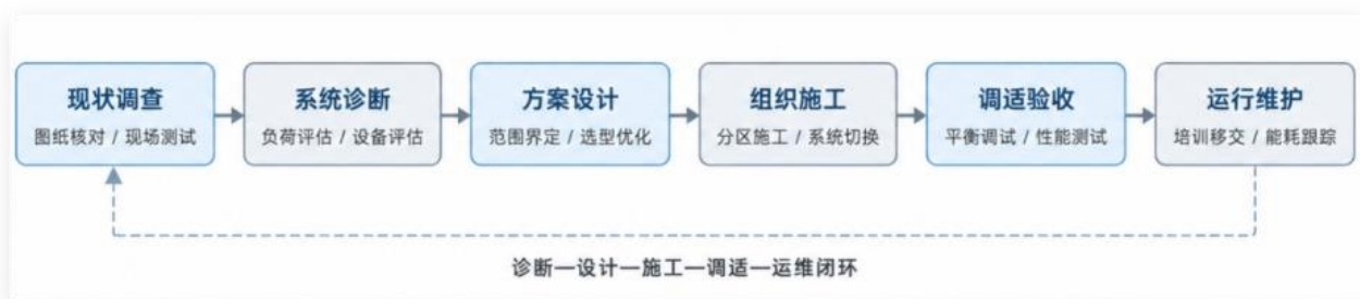
图1 既有建筑暖通空调系统改造实施流程
