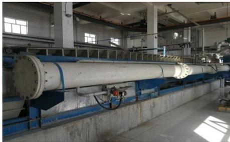
图1 滑台式脱水机
