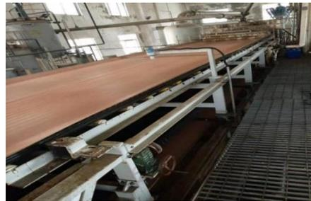
图2 皮带式脱水机
