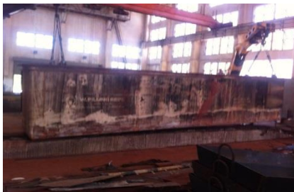
图 1 上海江南管业镀锌炉 (Westech) 锌锅 (W. PILLING) 使用后的情况
