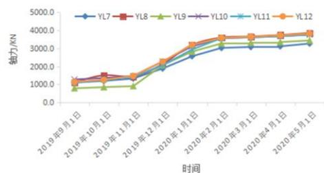
图11 栈桥板轴力值变化曲线图
