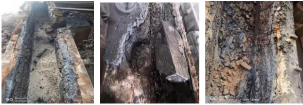
图2 下线后中间包包壁和包底情况
