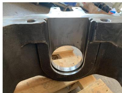
图2 安装座U型沟槽结构图
