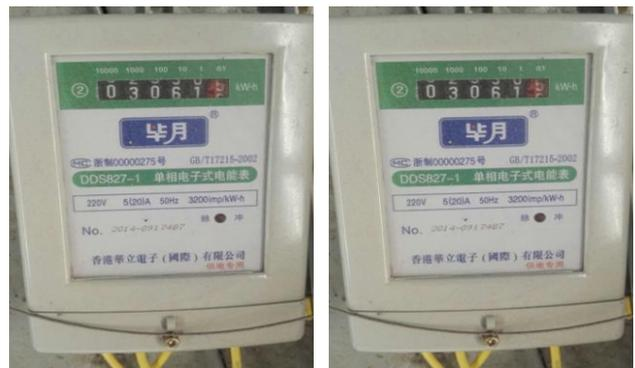
图 3 带防凝露控制器的单台柜体耗电      图 4 不带防凝露控制器的单台柜体耗电
