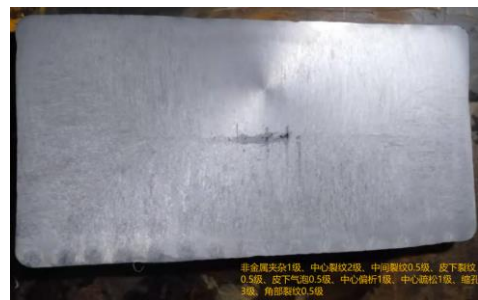
图 4 矩形坯缩孔、中间裂纹典型低倍图样
