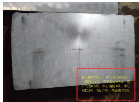
图 5 矩形坯内部裂纹及非金属夹杂典型低倍图样
