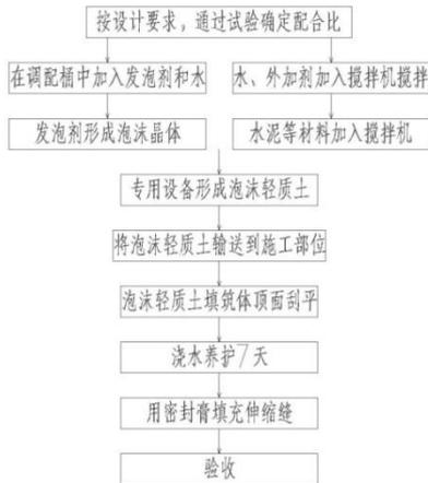
图 2 泡沫轻质土施工工艺流程图
