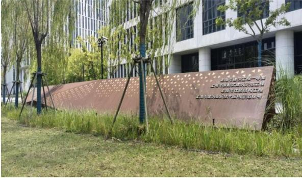
图1 耐候钢材料景墙使用示例图
