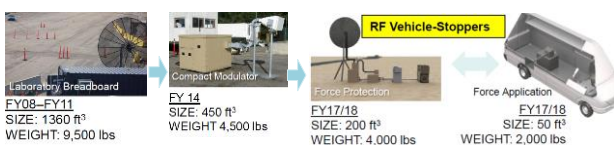
图 2 美国微波车辆迫停技术发展路线图
