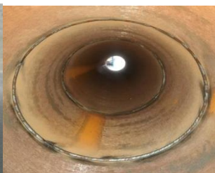
图2 打底焊缝成形
