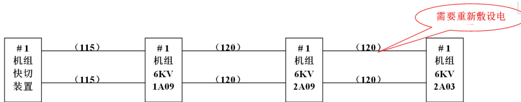
备用分支 1A09 和 2A03 断路器辅助接点电缆联系图
