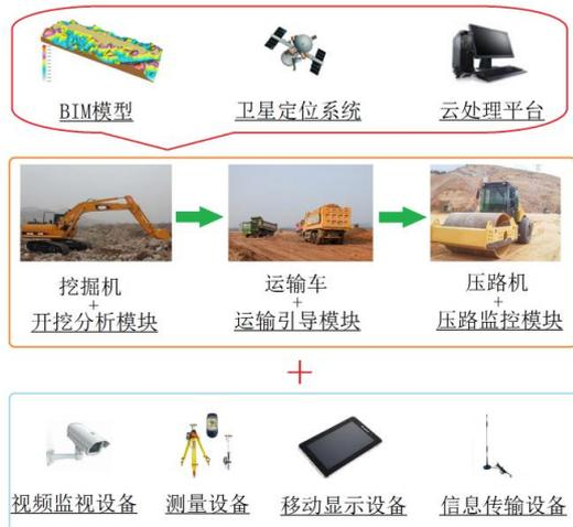
图3 土石方施工数字化系统组成
