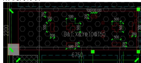
图3 机房楼板结构示意图
