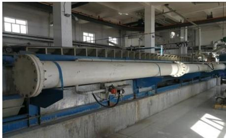
图1 滑台式脱水机
