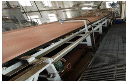
图2 皮带式脱水机
