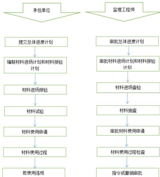
图 1 建筑工程监理流程
