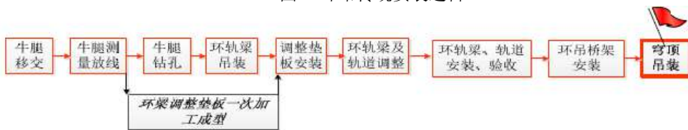
图 4 示范项目环吊安装逻辑
