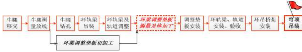
图 3 环吊传统安装逻辑
