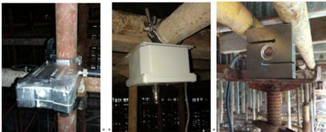
图 5: 双轴倾角传感器、位移传感器、轴压传感器
