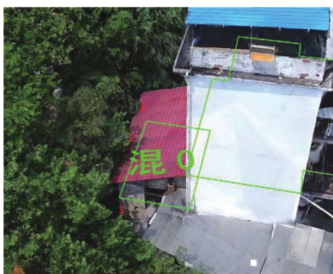
图3 部分遮挡房屋测量示意图
