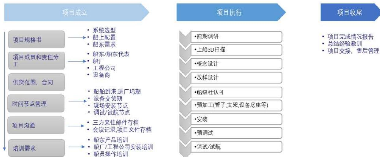
图 1-2 阿法拉伐的改装项目标准流程
