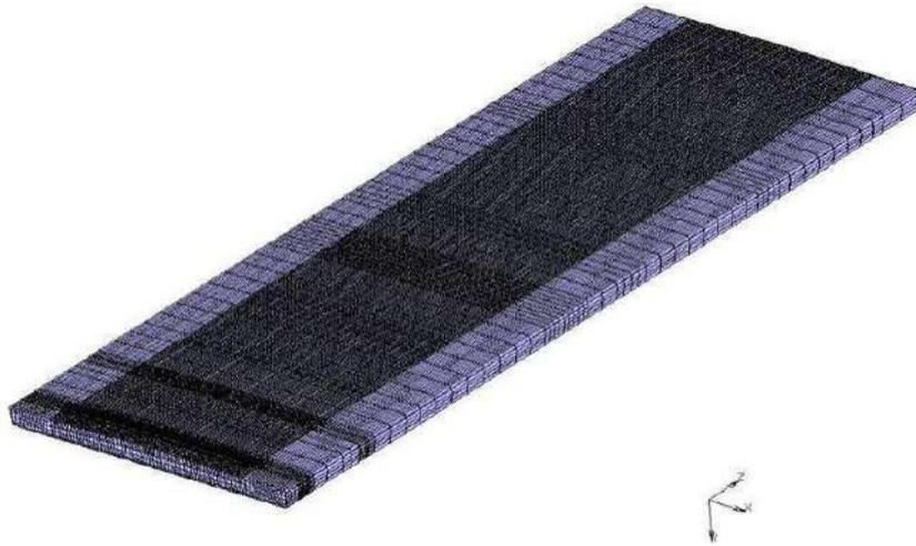
图 7 明州大桥主桥北侧边跨有限元模型
