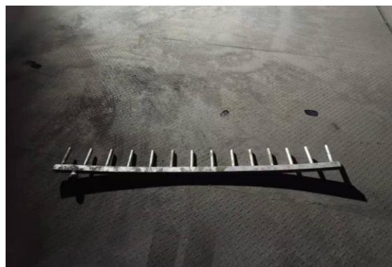
图7 二冷一段水条（过于密集、间距布置不合理）
