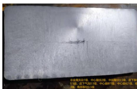
图 4 矩形坯缩孔、中间裂纹典型低倍图样
