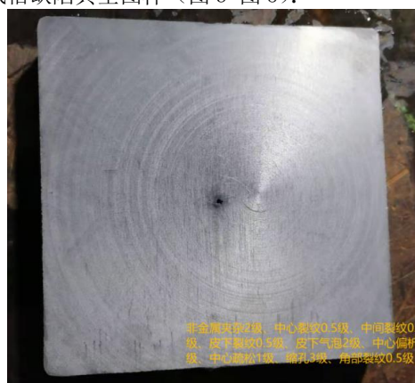
图 3 小方坯缩孔缺陷典型低倍图样
