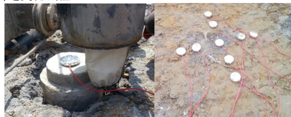
图6 复合地基承载力试验测点传感器布置
