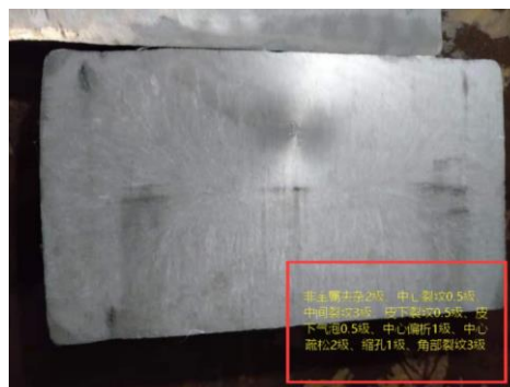
图 5 矩形坯内部裂纹及非金属夹杂典型低倍图样
