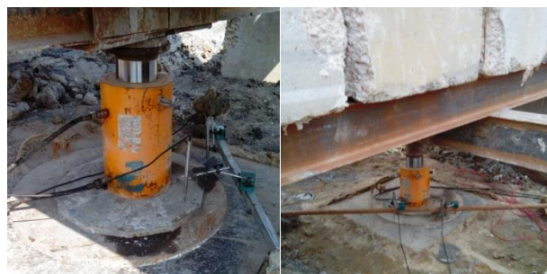
图2 单桩承载力现场测试
