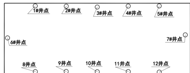
图 1 水池、地坑降水井平面布置图
