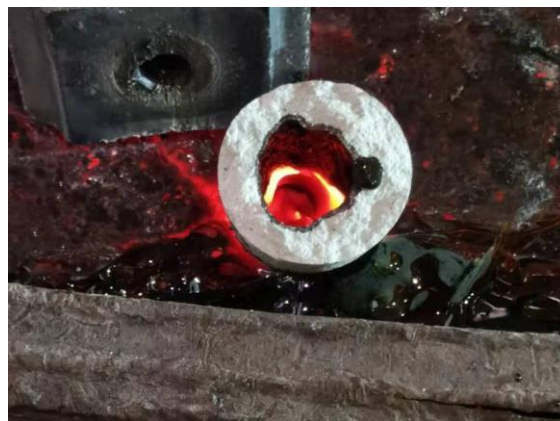
图9 结晶器浸入式水口侵蚀不均(造成结晶器内钢液流场异常)
