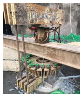
图11 抗压承载力检测
