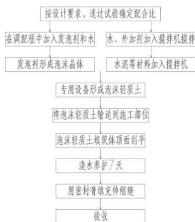
图2 泡沫轻质土施工工艺流程图
