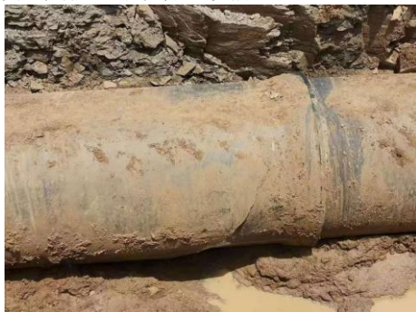
图9 因质量问题试压时管壁被打爆
