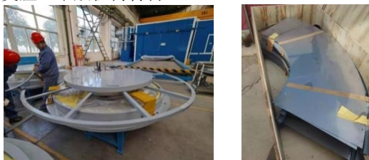
图9 支座防护罩支撑骨架及不锈钢板
