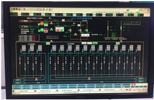
图6 改造前深调负荷125MW脱硝系统
