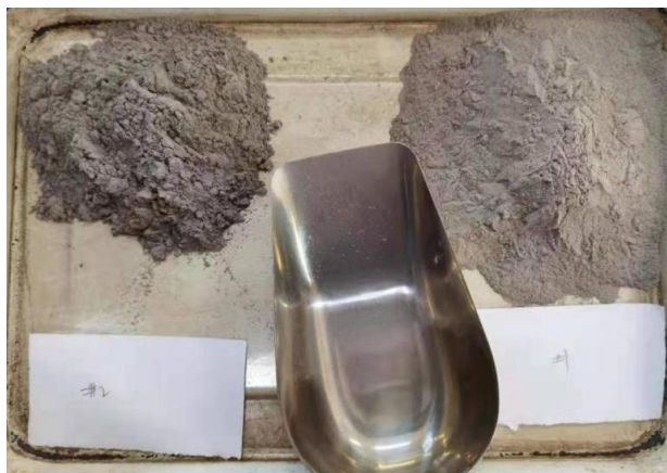
图 12 #1 锅炉和#2 锅炉飞灰取样对比
