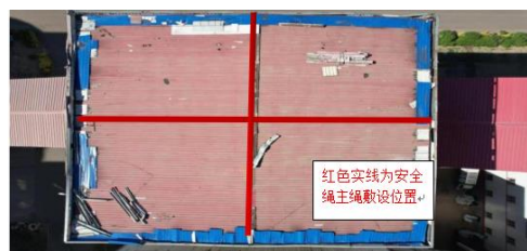
图 3 厂房顶安全绳布置
