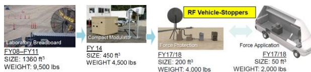
图 2 美国微波车辆迫停技术发展路线图
