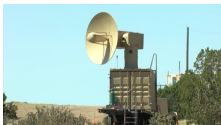
图 1 美国空军高功率微波反无人机装备 THOR
