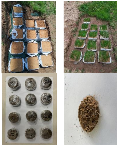
图1 根土复合体试样制备
