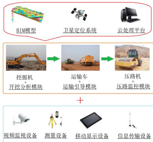
图3 土石方施工数字化系统组成
