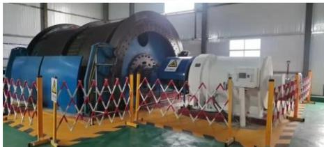
图1 现场使用永磁同步减速电机直驱矿井提升机
