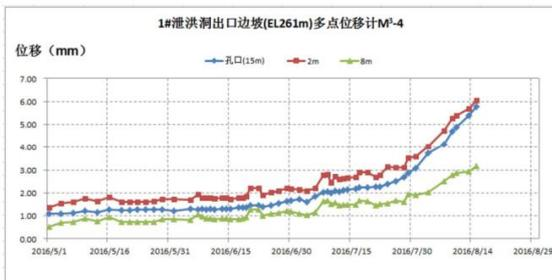
图 6 1#泄洪洞出口边坡 (EL261m) 多点位移计 M<sup>3</sup>-4
