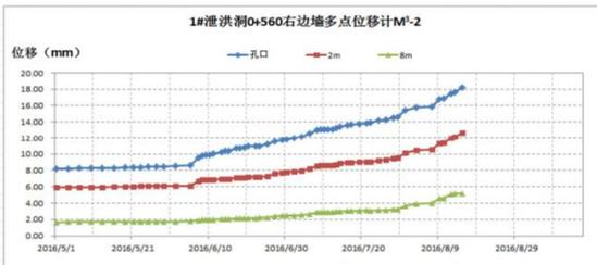
图 4 1#泄洪洞 0+560 右边墙多点位移计 M<sup>3</sup>-2
