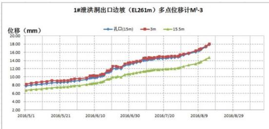
图 5 1#泄洪洞出口边坡 (EL261m) 多点位移计 M<sup>3</sup>-3
