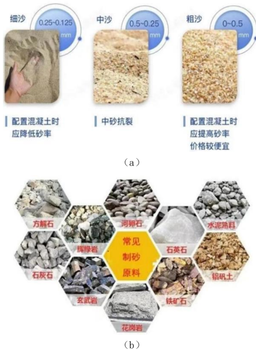
图1 (a) 机制砂的规格; (b) 机制砂的原料
