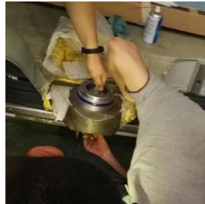
图7 铰接轴承拆卸
