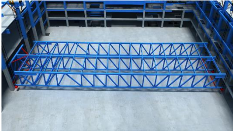
图8 试提升静载过程示意图
