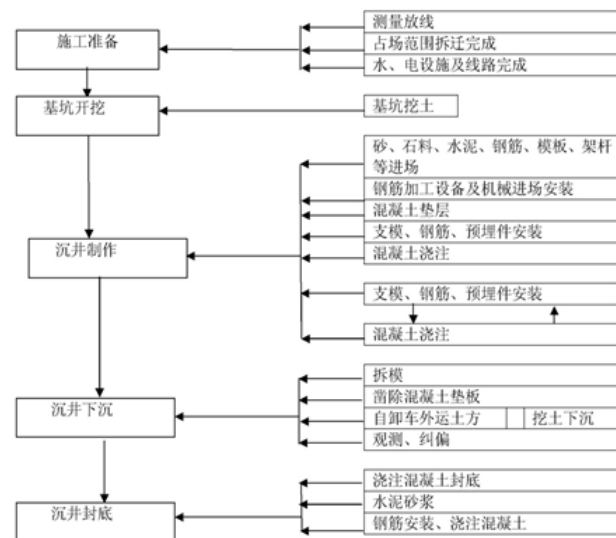
图2 沉井施工工艺流程
