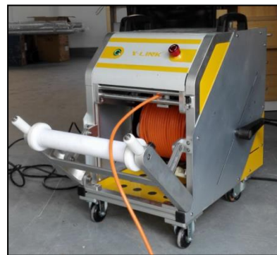
图5 管道机器人操纵线缆架
