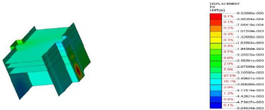
图 13 B 坑开挖及回筑工况 11 号线结构 X 向变形云图
