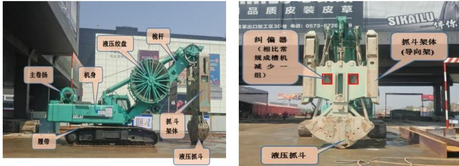
图 9 SG40L 型低净空成槽机
