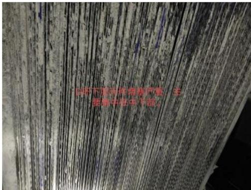
**图 7 D 环下层蓄热元件堵塞情况**
