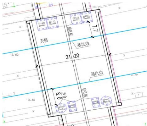
图3 天桥与车站基坑平面示意图
