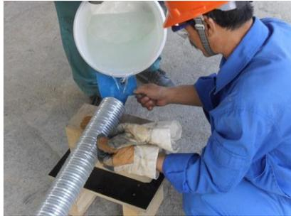
图2 波纹管检漏试验
