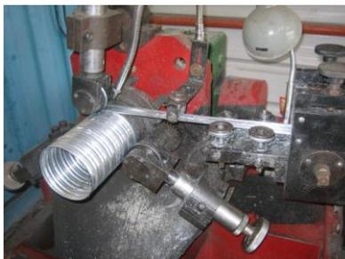
图 1 金属波纹管制作
