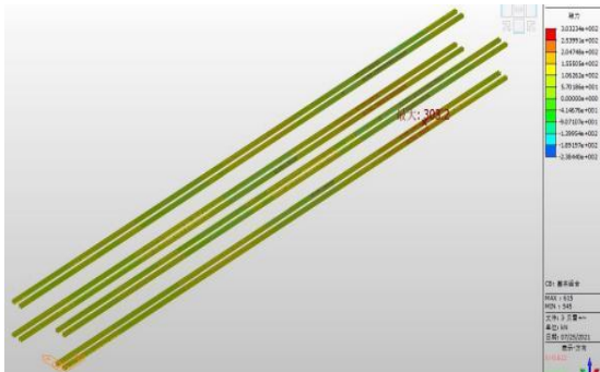
图 1 贝雷梁弦杆内力图
