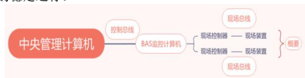
图3 智能建筑楼宇自动化系统
