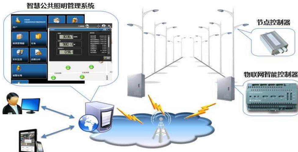
图2 智能电气照明系统
