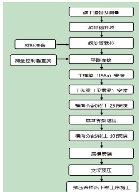
图 6 支架施工工艺流程图
