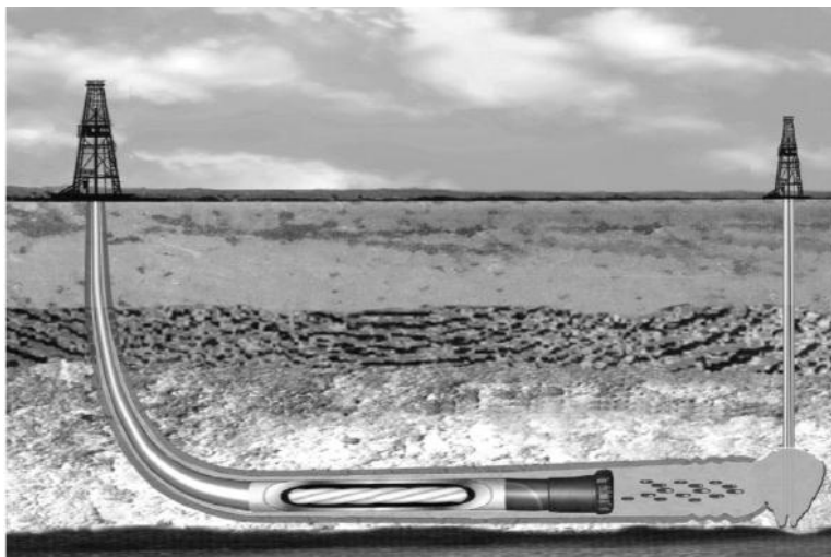
图1 定向水平井连通法示意图
