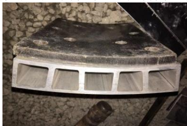
图 1 气囊内径膨胀推动闸瓦片效果图
