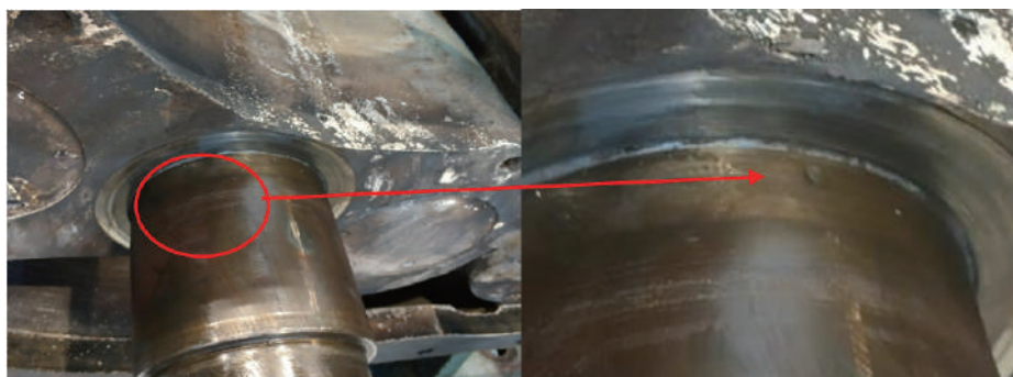
图1 图2 防转销断裂, 转子端面有磨痕
