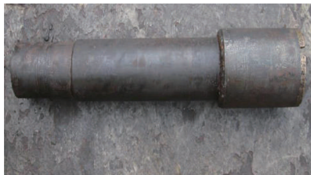
图1 焊接有套铣头的母锥 (有利于鱼顶进入母锥腔内)
