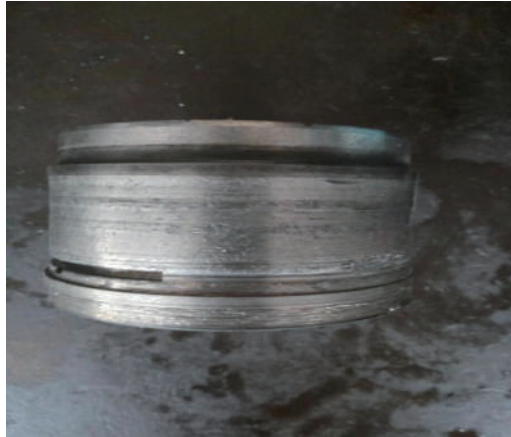
图6 密封垫及活塞环磨损
