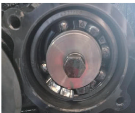
图5 轴承保持架断裂
