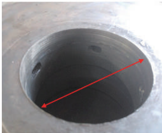
图7 密封腔内孔磨损
