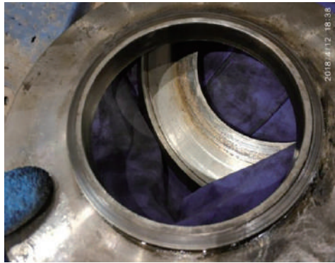
图3 甩油盘轴向端面有磨痕
