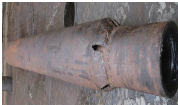
图4 焊接有引鞋的LM-S73双滑块捞矛
