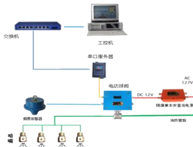
图1 自动报警灭火装系统组成图
