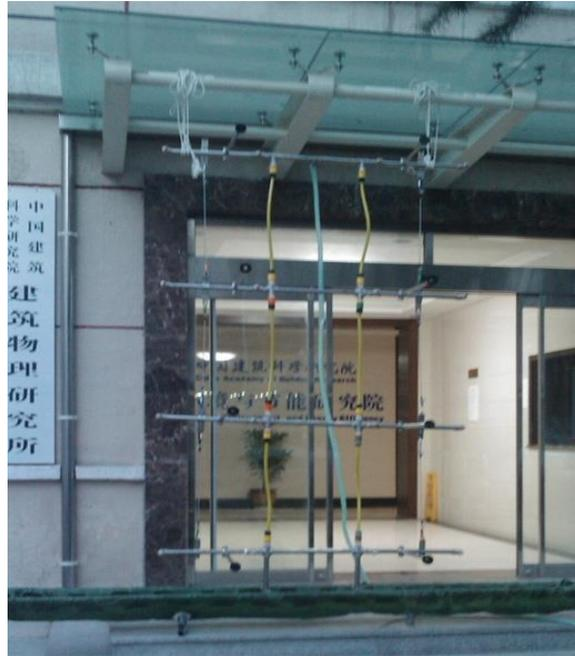
图1 外喷淋装置
