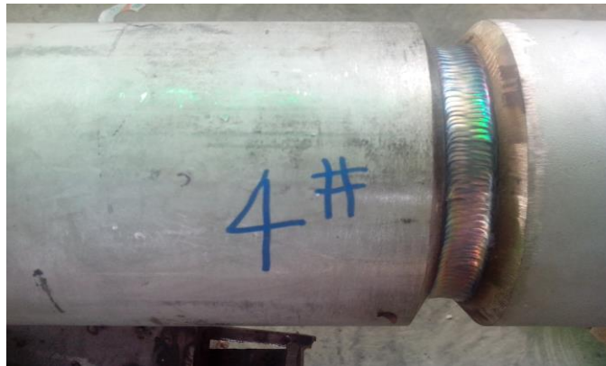
图 1 焊接接头为 V 型坡口，氩弧焊打底
