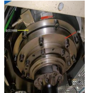
2 盘式压力传感器与主轴的安装配合
