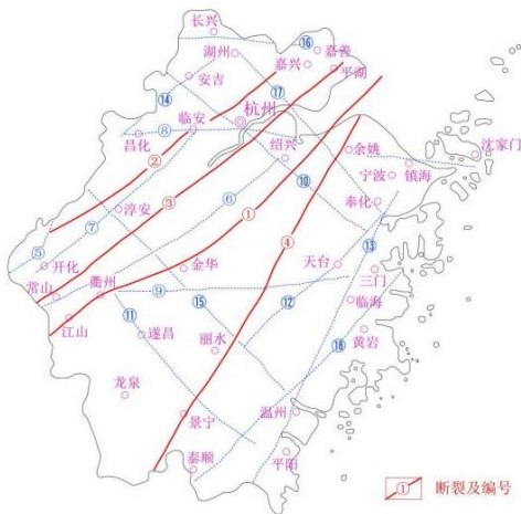
图2 浙江省断裂系统图
