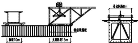
图4 桥面吊机施工示意图
