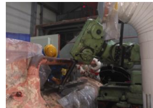
图 7 外缸外缸顶开螺孔加工场景
