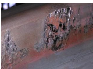
图12 内缸粘结拉伤情况
