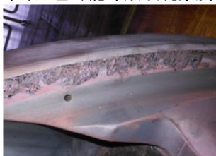
图11 内缸凸肩粘结情况
