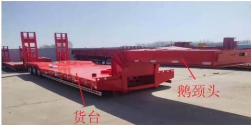
图 13 半挂平板车结构实物图
