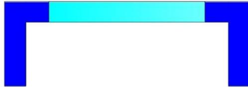
图5 一字型分段横梁+L立柱分段图
